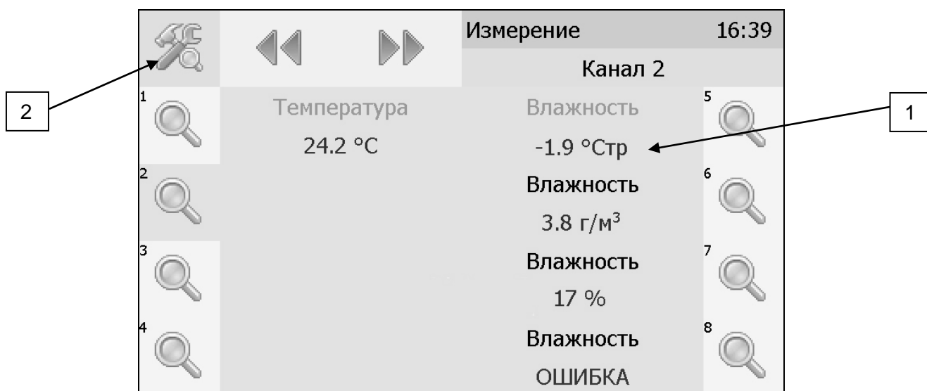
Рисунок 6.3 Вызов экрана настройки канала измерения
