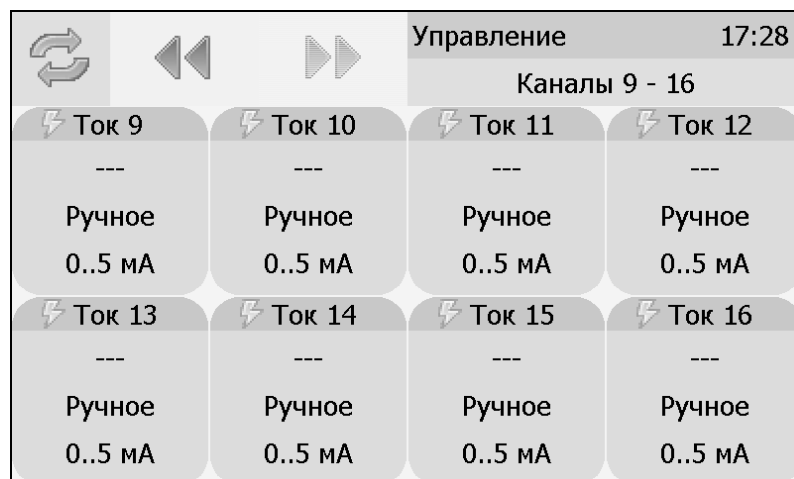
Рисунок 6.14 Режим отображения каналов управления (а – каналы «реле», б – каналы «ток»)
