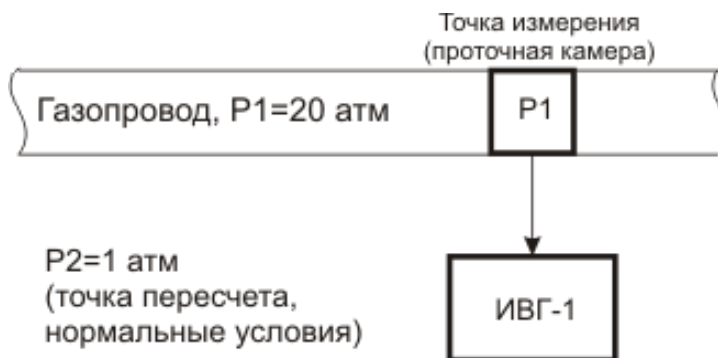
Рисунок 6.11 Пример использования пересчета показаний влажности.
